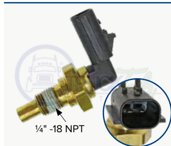
DETROIT OEM 23527830 Sensor de temperatura de aceite o refrigerante
