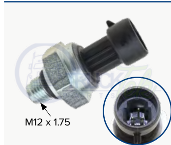
INTERNATIONAL OEM 1834538C91, 1839412C91 Sensor de presión de aceite
