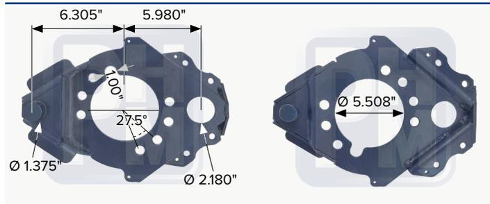
Araña porta zapata tipo Bendix derecha
