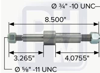
Soporte inferior para amortiguador, con tratamiento térmico
