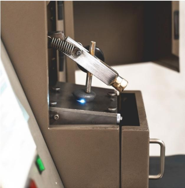
Realizamos pruebas de espectrógrafo para comprobar el balance perfecto de contenido de metales en nuestros productos y así asegurarnos de su dureza.
